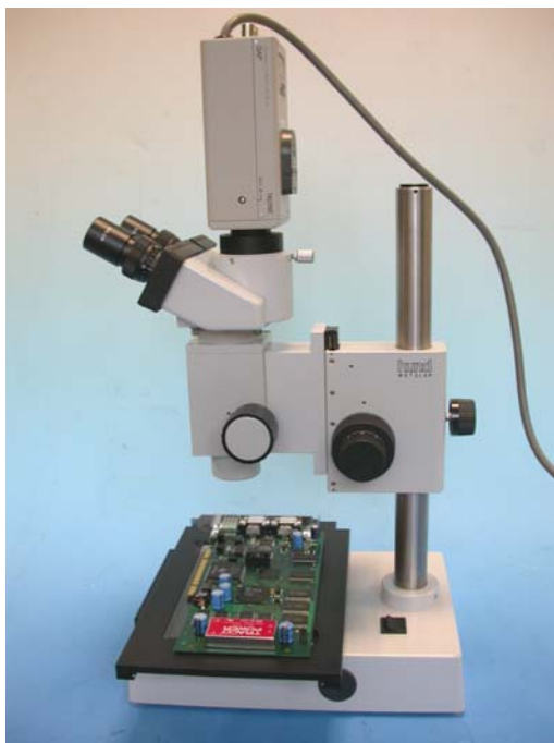
Binofototubus 30/70 70 % des Lichtes gehen zur Videokamera
