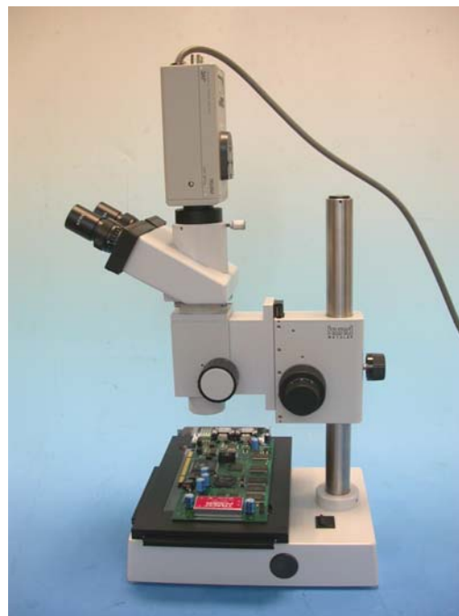
Binofototubus 100/100 (umschaltbar) 100 % des Lichtes gehen wahlweise zum Beobachter bzw. zur Kamera
