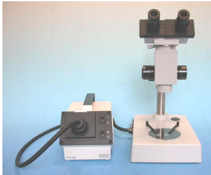
Zoom Mikroskop ZM am Stativ mit Durchlicht-Hellfeld und Durchlicht-Dunkelfeld-Beleuchtung.
